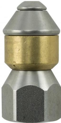
Ce gicleur HP rotatif en acier inoxydable et laiton est conçu pour déboucher les canalisations d'un diamètre compris entre 50 et 150 millimètres. Ses trois jets propulseurs rotatifs permettent de propulser le flexible sur lequel il est monté et de déboucher les canalisations encrassées. Le gicleur doit être utilisé uniquement lorsque la canalisation est vide pour une efficacité optimale contre les graisses et le calcaire incrustés.
